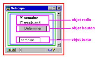
Dans ce formulaire, on trouve deux radio-boutons, un bouton classique et une zone de texte. Ce sont respectivement l'objet <u>radio</u>, l'objet <u>button</u>, l'objet <u>text</u>.
